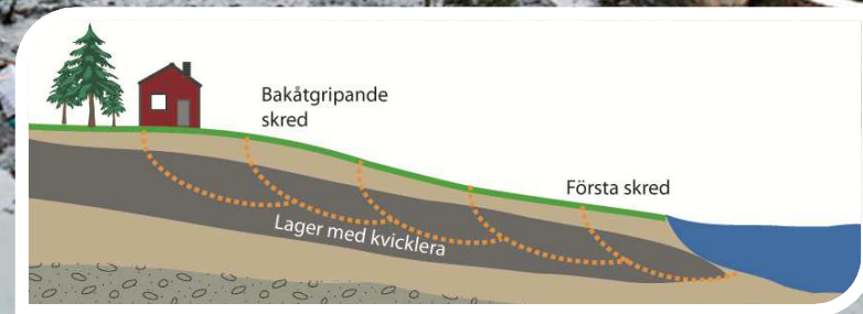
Principen för ett kvicklereskred
